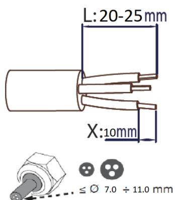
На концы проводов установить втулочные наконечники согласно спецификации, монтаж наконечников производить по типовой инструкции.
