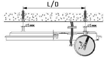
4 Установить корпус на поверхности потолка. Вставить в крепежные отверстия заглушки.
