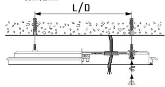
5 Подключить сетевой провод к драйверу в соответствии с указанной полярностью:
