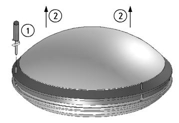
2 Снять плату с LED-модулями:
